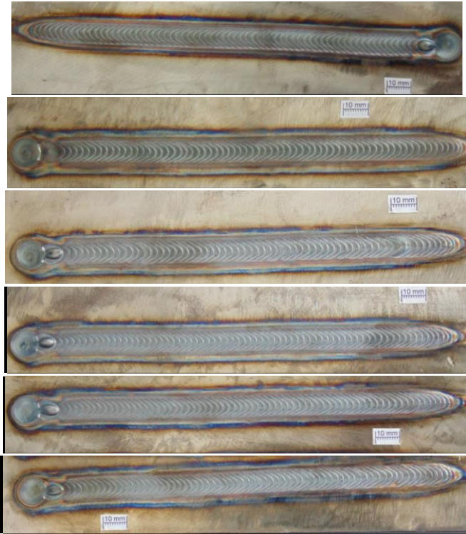
Figura 39 - Cordões de solda com switch back de acordo com a Tabela 8
