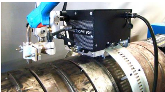
Figura 8- Manipulador de solda Tartfilope V2F desenvolvido especialmente para soldagem orbital de tubos
