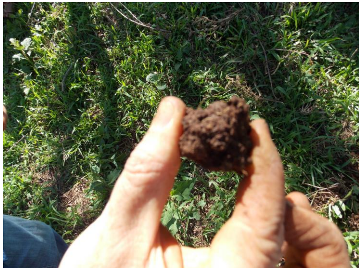
Figura 15 - Avaliador submetendo um torrão à pressão dos dedos.
