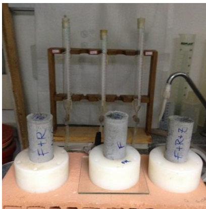
Figura 37: Aparato utilizado no ensaio de absorção de água por capilaridade.
