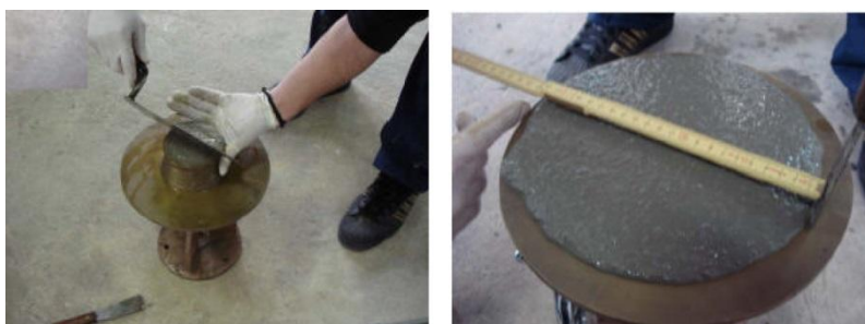
Figura 14: Ensaio de Espalhamento. Lado esquerdo: Nivelamento (arrasadura) do mini cone. Lado direito: Medidas ortogonais dos diâmetros.
