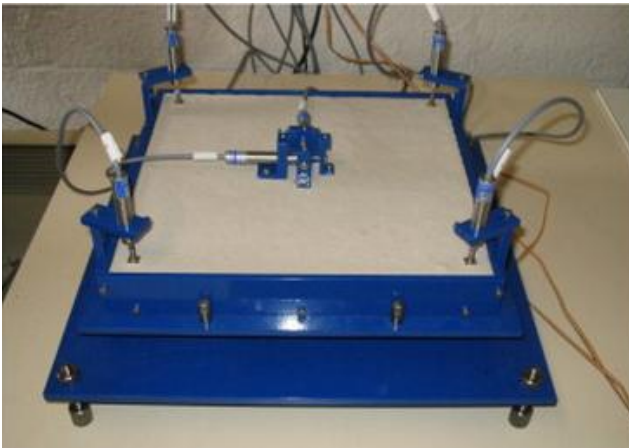
Figura 21: Aparato utilizado para medir os empenamentos das bordas ( curling ). Fonte: Le-Bihan et al. (2012).
