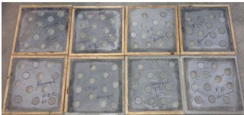
Figura 64: Amostras após ensaios de resistência de aderência à tração.
