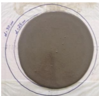
Figura 31: Ensaio de espalhamento na mesa.
