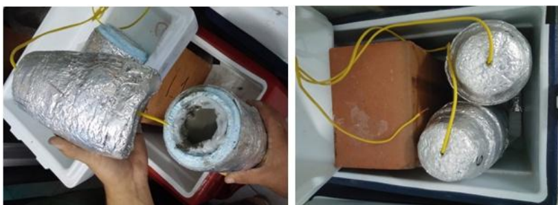
Figura 33: Recipiente cilíndrico e Fio Termopar (esquerda) e Amostra na Caixa Térmica (direita).
