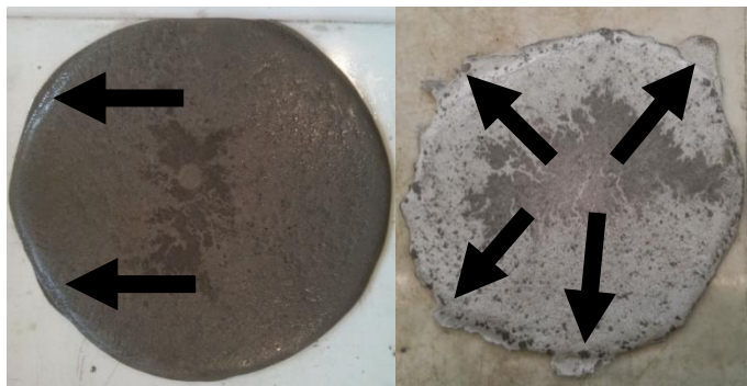
Figura 49: Sinais de exsudação em argamassas autonivelantes de referência (FC10) dispostas em placas de vidro.
