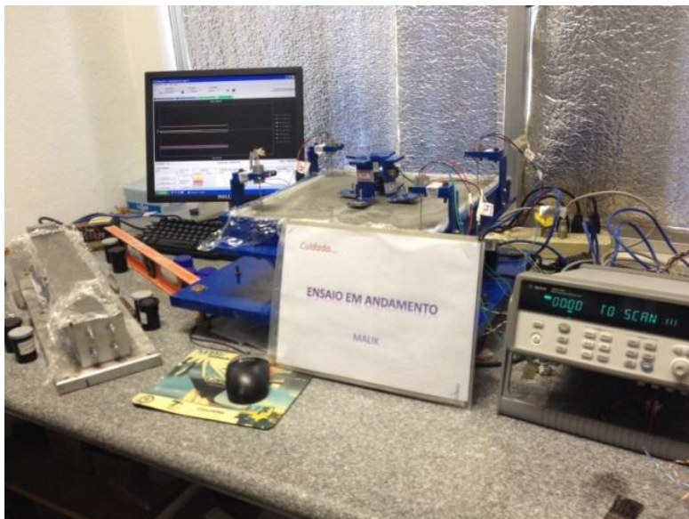
Figura 39: Aparato utilizado nos ensaios de Curling e Retração Linear.
