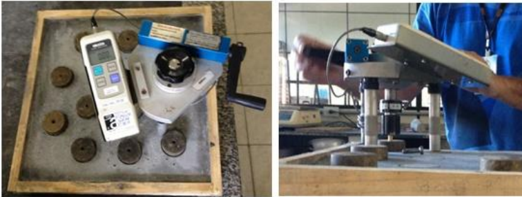
Figura 38: Aparato Utilizado no Ensaio de Aderência à Tração.
