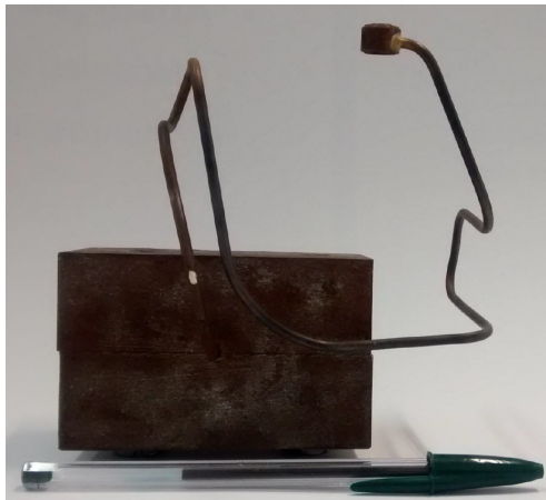
Figura 86 – Configuração do teste proposto para o tubo de descarga.
