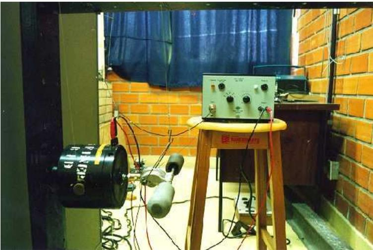
Figura 4.7 – Foto do experimento durante os ensaios dos PED-P (protótipos), com detalhe da união entre o excitador eletrodinâmico, a cabeça de impedância, e o protótipo.
