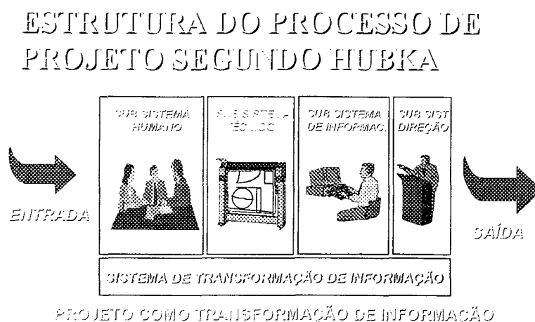
Fig. 3.1 Projeto como transformação de informação segundo HUBKA.
