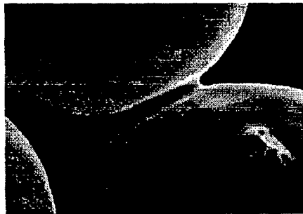
FIGURA 3: Imagem de um contato formado entre partículas durante a sinterização (GERMAN, 1984)
