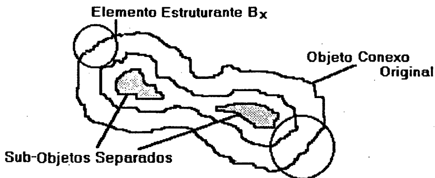
Figura 1.3.4.2. Erosões sucessivas, determinando a existência de uma garganta.
