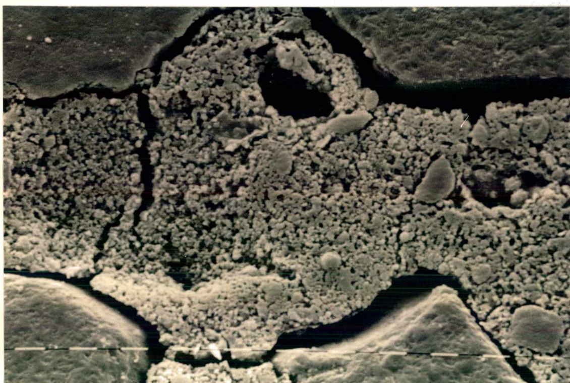
Figura 3.4 - Micrografia da argamassa de cimento e cal. Ampliação 400X. Escala 10 \mu m. Amostra polida [39].
