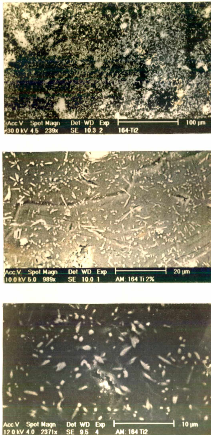
FIGURA 21 - Micrografias obtidas em MEV da frita 164 com adição de 2% TiO 2 .
