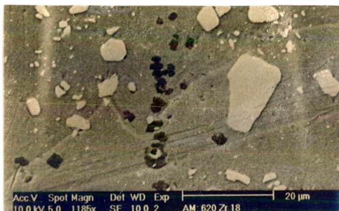
FIGURA 38 - Microscopia eletrônica da frita 620 com adição de 18% de ZrSiO_4 .
