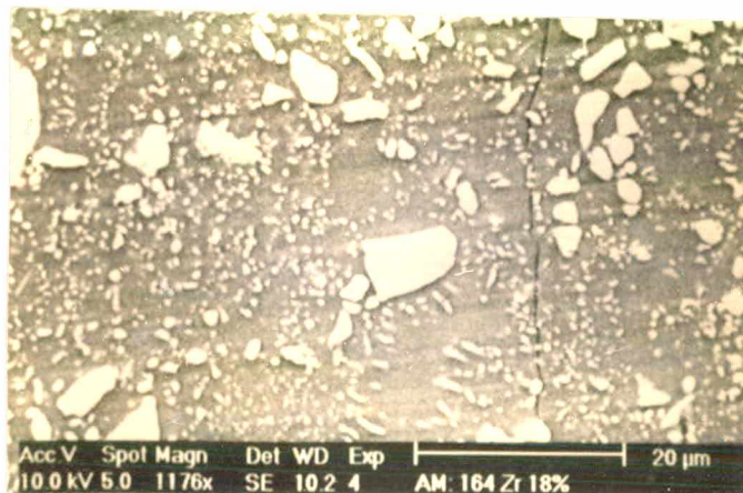
FIGURA 24 - Microscopia eletrônica da frita 164 com adição de 18% de silicato de zircônio (Zr).
