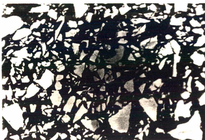
Figura 33 - Micrografia do pó antes da moagem
