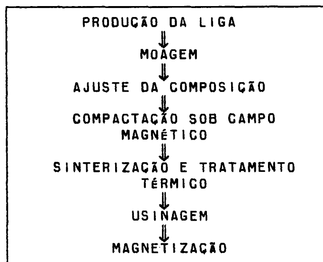
Figura 1 - Fluxograma da produção de ímãs de \text{SmCo}_5
