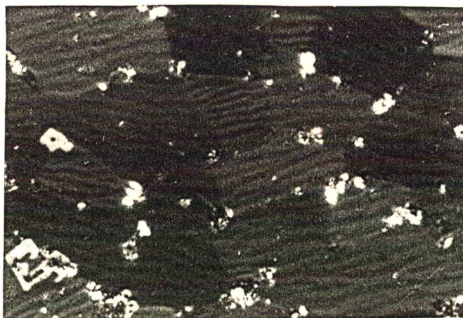
Figura 37 - Micrografia de uma amostra mostrando o alinhamento dos domínios magnéticos. Luz polarizada
