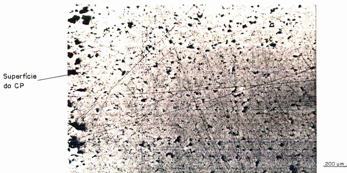
Figura 57 - Diferença de porosidade entre núcleo e periferia dos corpos sinterizados.
