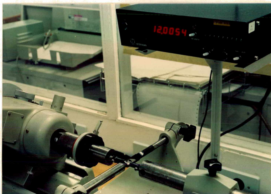
FIG. 4.1 - Regulagem do alargador com auxílio de metroscópio horizontal
