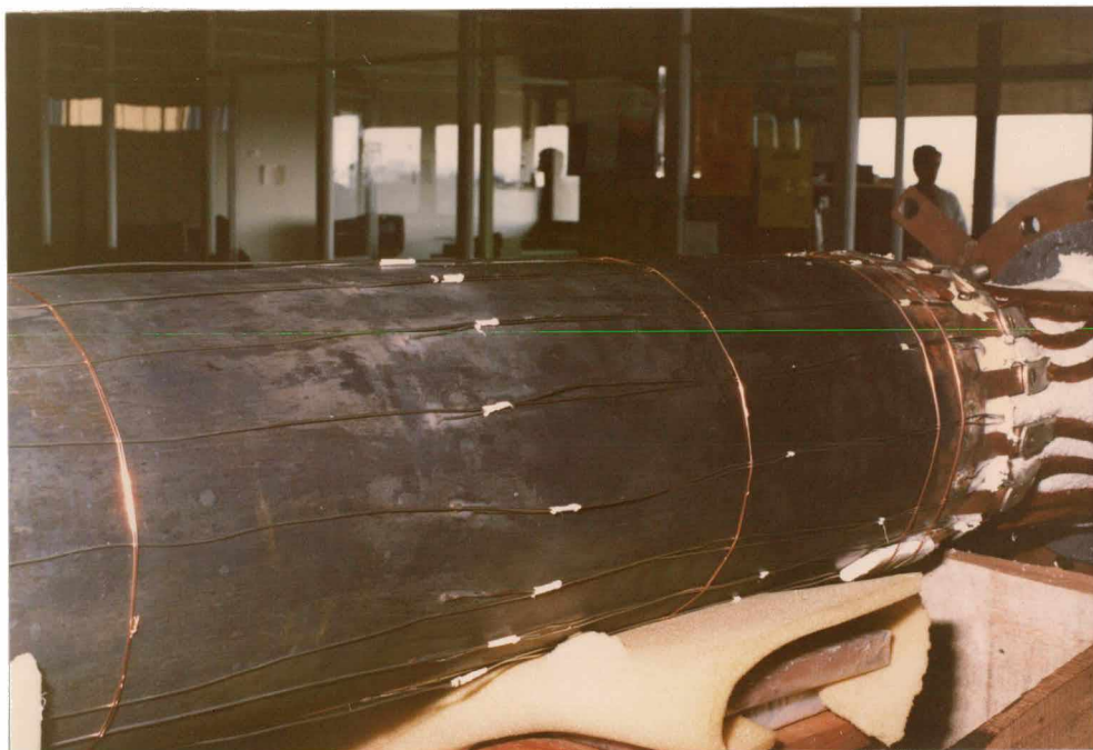
Figura 3.11 - Montagem da carcaça interna. Detalhe da colocação dos termopares no tubo de cobre.
