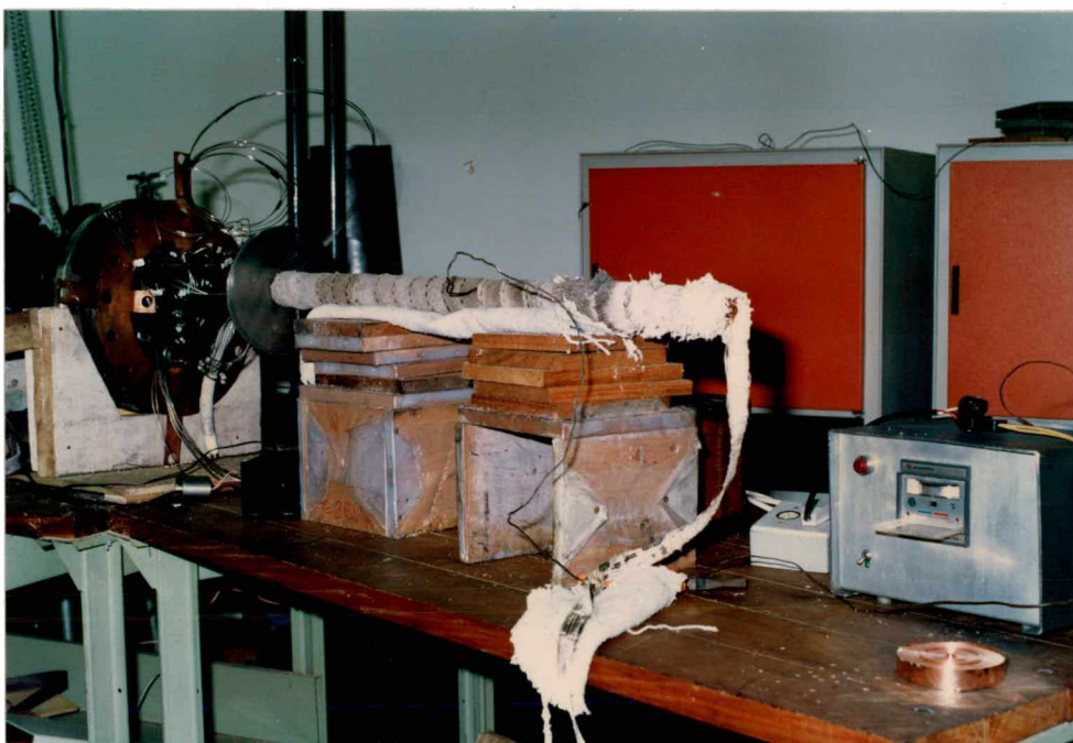
Figura 3.4 - Confeção do cabo. Aplicação das fitas de Mylar e cobre sobre o material isolante.
