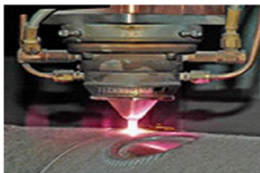
Cladding e revestimento
