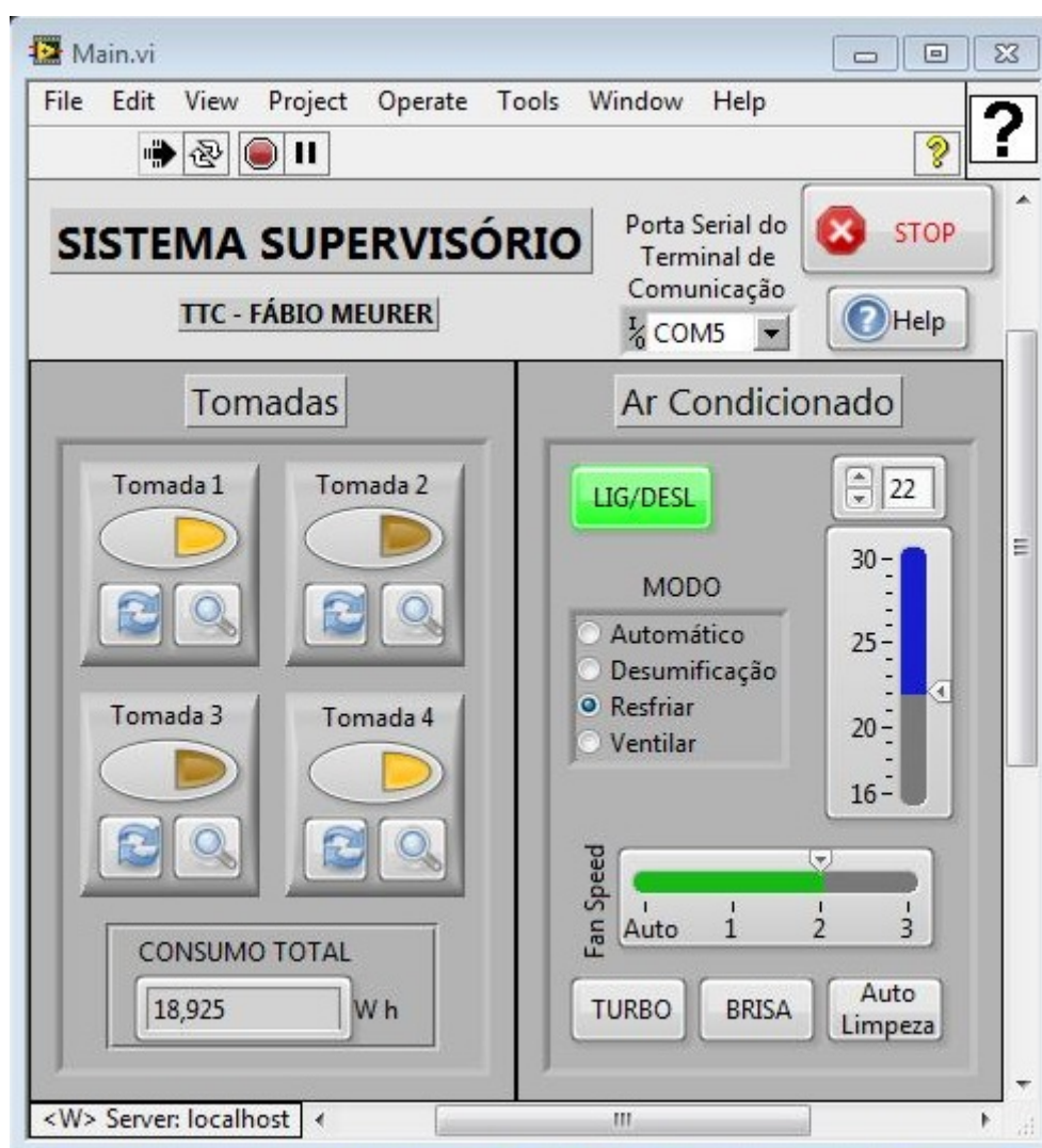
Figura 29 – Painel frontal do sistema supervisorio.
