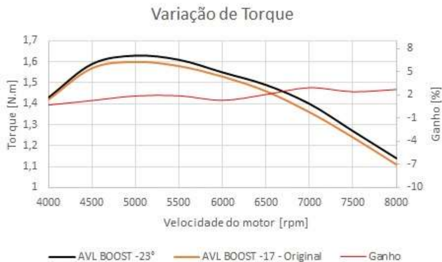
Figura 26 - Ganho de torque com alteração predeterminado do ponto de ignição.
