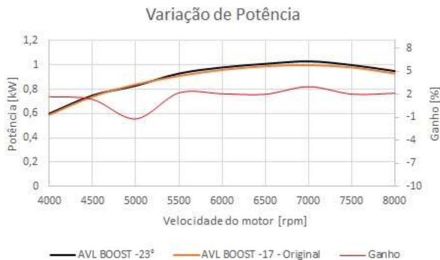
Figura 25 - Ganho de potência com alteração predeterminada do ponto de ignição.
