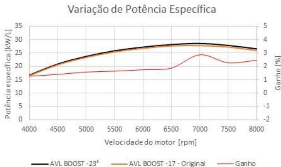
Figura 27 - Ganho de potência específica com alteração predeterminada do ponto de ignição.
