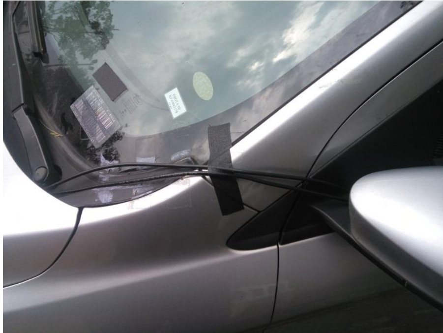
Figura 33 – Passagem de cabos necessária para conectar o Rotec aos sensores.
