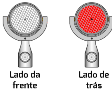
Figura 26 - Refletores circulares planos biaxiais bireflexíveis.
