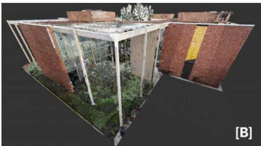
Figura 85 - Visão da nuvem de pontos do Laser Scanner e das fotos.
