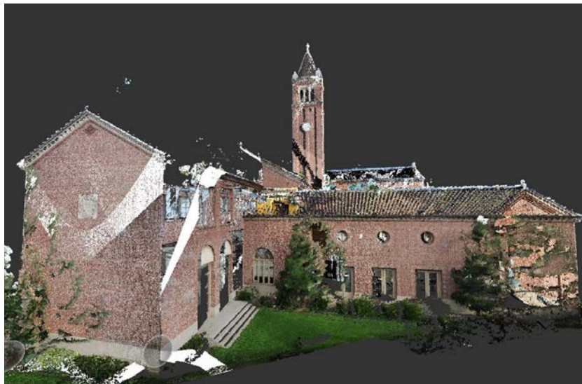
Figura 49 - Nuvem de pontos da fachada sul do Mudd Hall.
