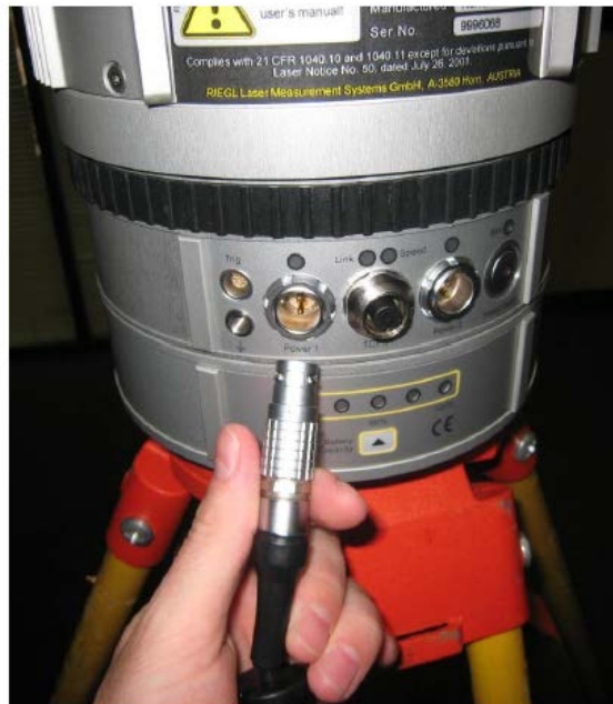
Figura 31 - Cabo de alimentação de energia.
