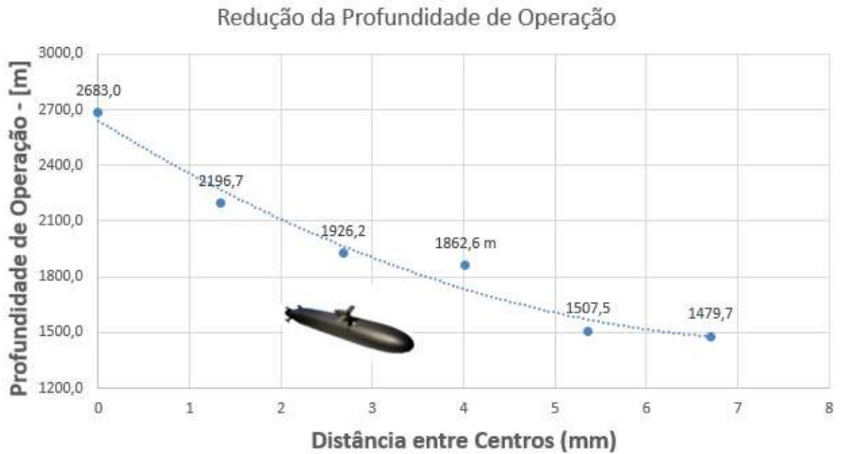
Figura 45: Redução da profundidade de operação de acordo com a distância entre centros.
