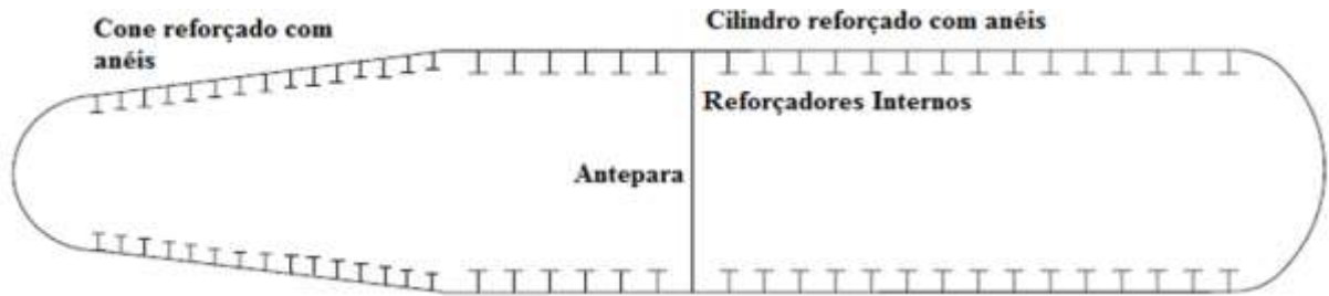
Figura 1: Típica estrutura do casco de pressão de um submarino
