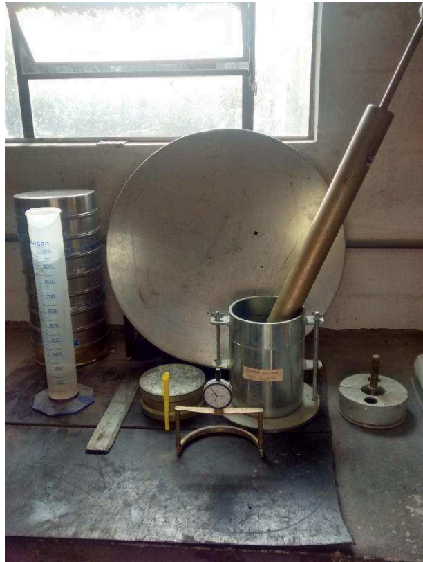
Figura 10 – peneiras, proveta, régua biselada, disco espaçador, extensômetro, cilindro, soquete, sobrecarga e disco poroso.
