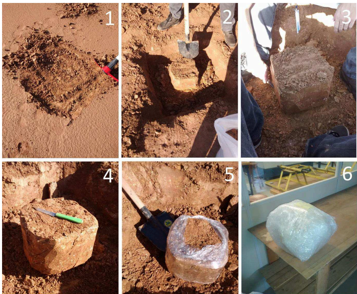
Figura 8 - (1) demarcação do local da coleta, (2) fase preliminar da coleta, (3) preparação para retirada da amostra, (4) amostra pronta para ser retirada, (5) retirada da amostra, (6) amostra acondicionada.
