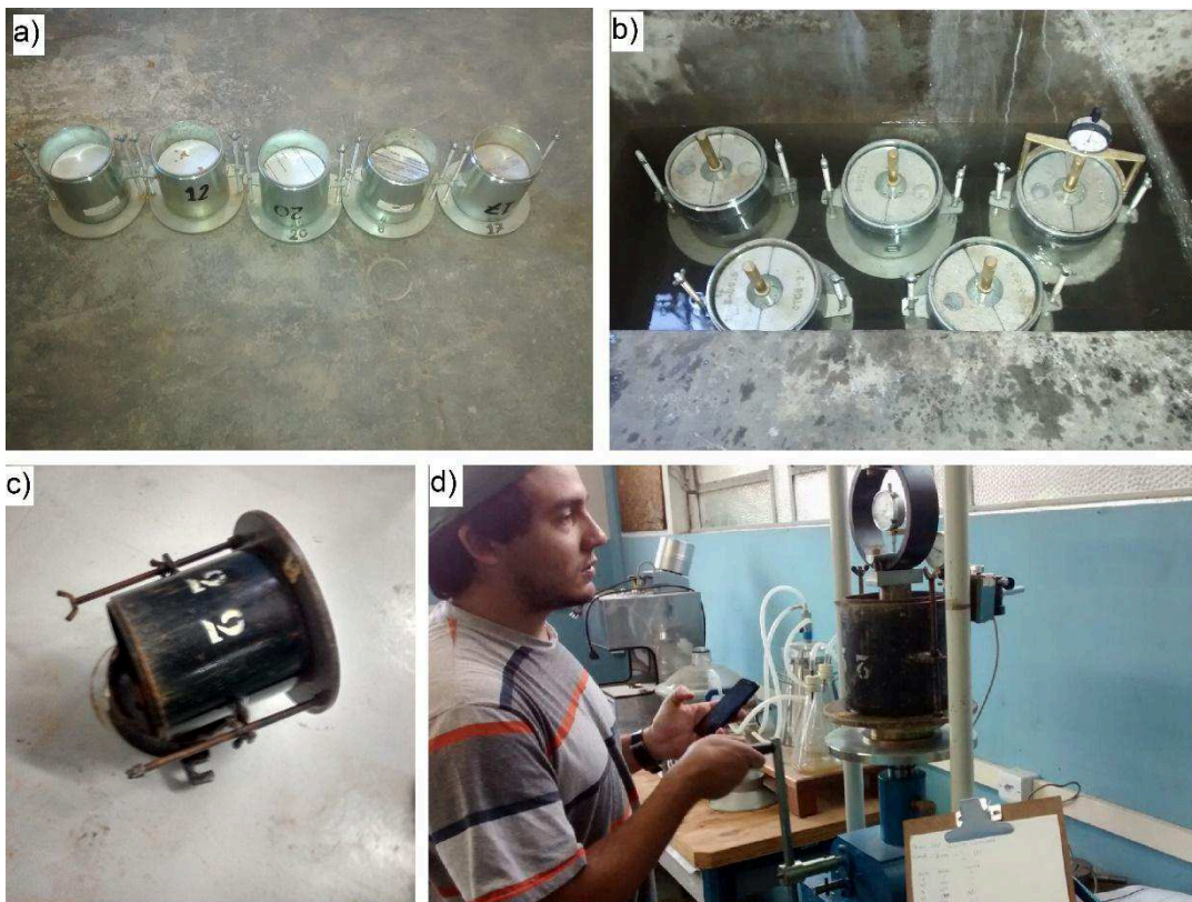
Figura 12 – (a) Amostras preparadas para imersão; (b) imersão das amostras; (c) escoamento de água em excesso pós-imersão; (d) execução do ensaio CBR.
