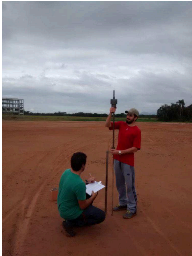
Figura 16 - Execução do ensaio DCP in situ .
