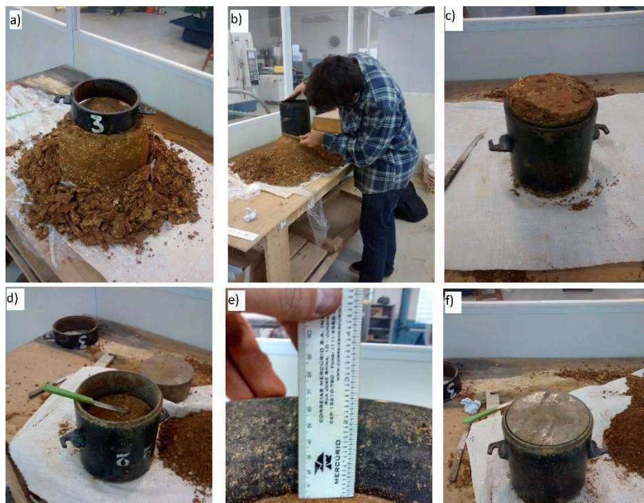
Figura 13 – (a) preparo inicial; (b) moldagem do corpo de prova com um faca; (c) amostra moldada no cilindro; (d) arrasamento e retirada de 6,6cm de solo do cilindro; (e) verificação da espessura de solo retirada; (f) amostra prova para imergir.
