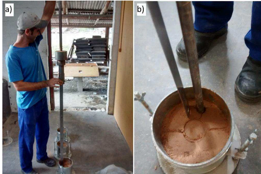
Figura 15 – (a) execução do ensaio DCP em amostra; (b) local da execução na amostra.
