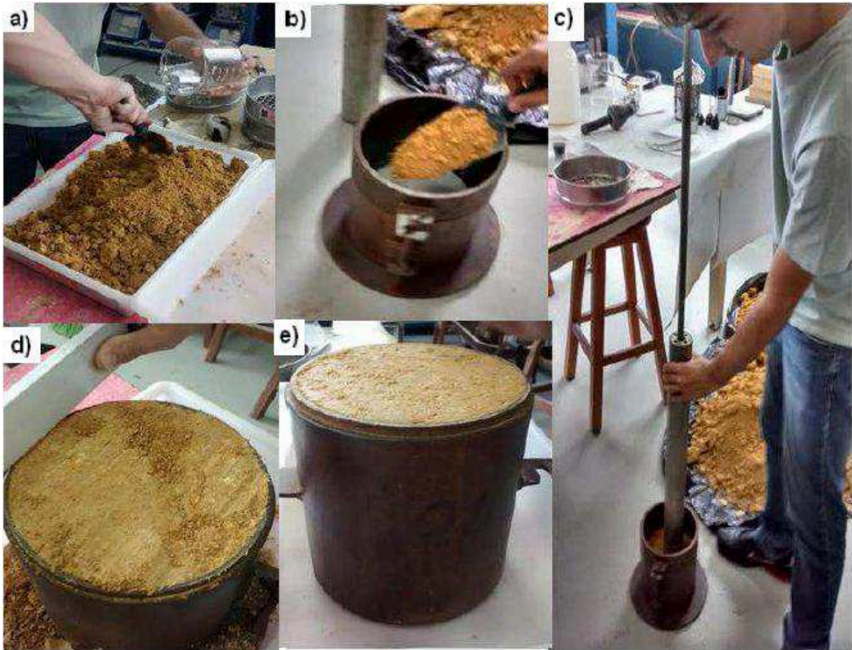
Figura 9 – (a) acréscimo de água; (b) colocação solo no cilindro; (c) compactação; (d) arrasamento; (e) cilindro rasado.
