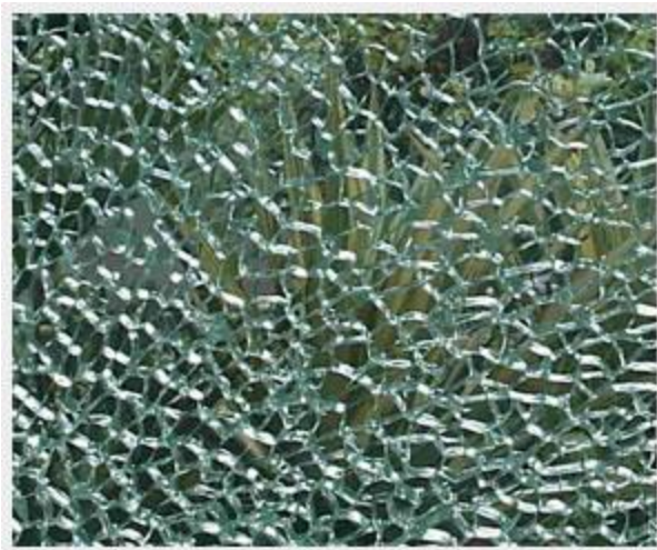
Figura 7 – Vidro temperado após a quebra
