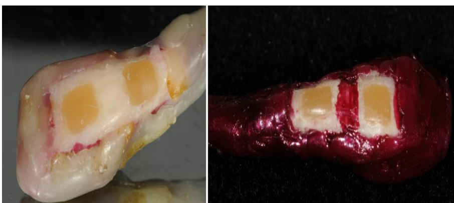
Figura 5: Impermeabilização dos espécimes com cera pegajosa e esmalte.
