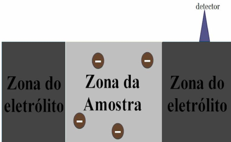
Na próxima etapa, representada pela Figura 12, quando a diferença de potencial é aplicada para formação do *stacking*, íons borato penetram na zona da amostra e aumentam o pH daquela zona, e a fração molar de MP ionizado aumenta gradativamente e proporcionalmente ao tempo de aplicação da diferença de potencial. O fluxo eletrosmótico também está presente durante a realização do *stacking* e é esse fluxo que empurra os íons borato para dentro da zona da amostra.
