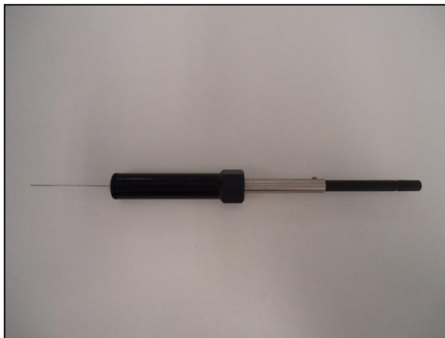
Figura 7. Fibra de SPME e suporte utilizado para análise dos compostos BTEX.
