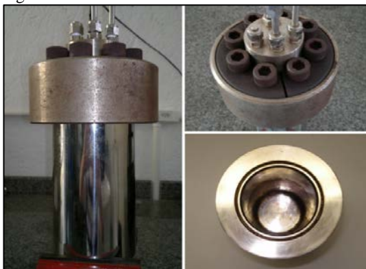
Figura 26 - Reator batelada Inconel 243HC5.
