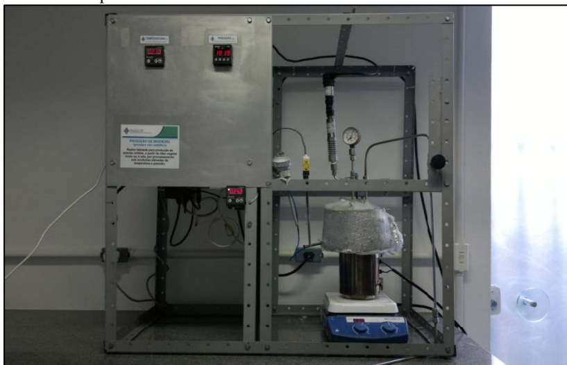
Figura 28 - Unidade experimental utilizada para transesterificação não catalítica com álcool supercrítico.
