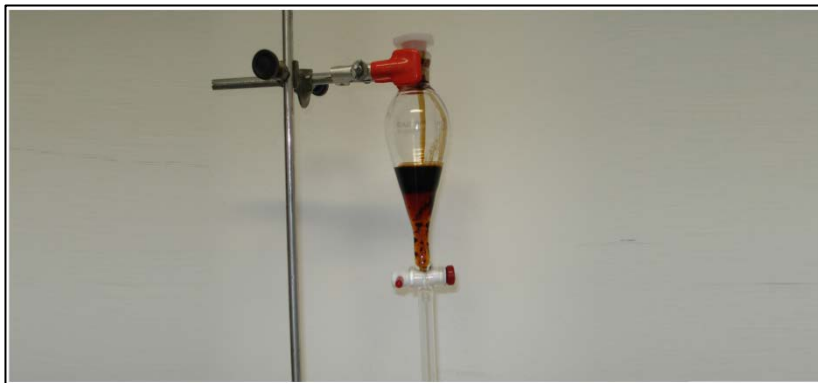
Figura 36 - Separação de fases após transesterificação do óleo in situ de tungue: corrida 09T.
