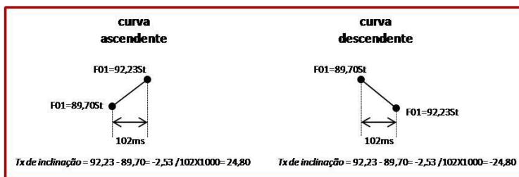
Figura 2.15: Modelo de cálculo para taxa de inclinação de F0, fundamentado em Colamarco (2009)
