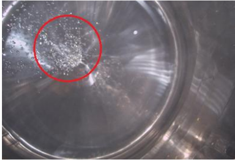
Figura 4.1 Detalhamento do procedimento de enxágue do fermentador, mostrando que os jatos de água do spray-ball não atingem as paredes do tanque.
