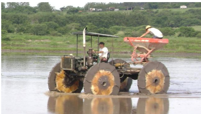
Figura 8: Semeadura mecanizada: Trator adaptado pelos agricultores “chupa cabra”
