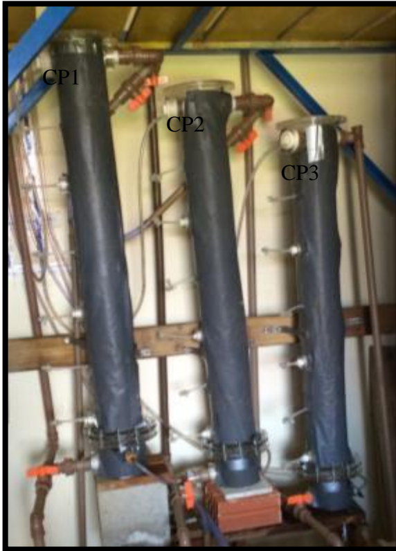
Figura 15 - Colunas de pré-filtração.
