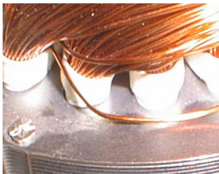
Figura 24 – Condutor em contato com as lâminas na parte externa do estator.
