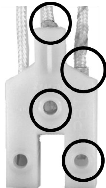
Figura 62 – Caixa de tomadas com defeito em dois cabos. Em destaque, a alteração visual causada pelos defeitos.
