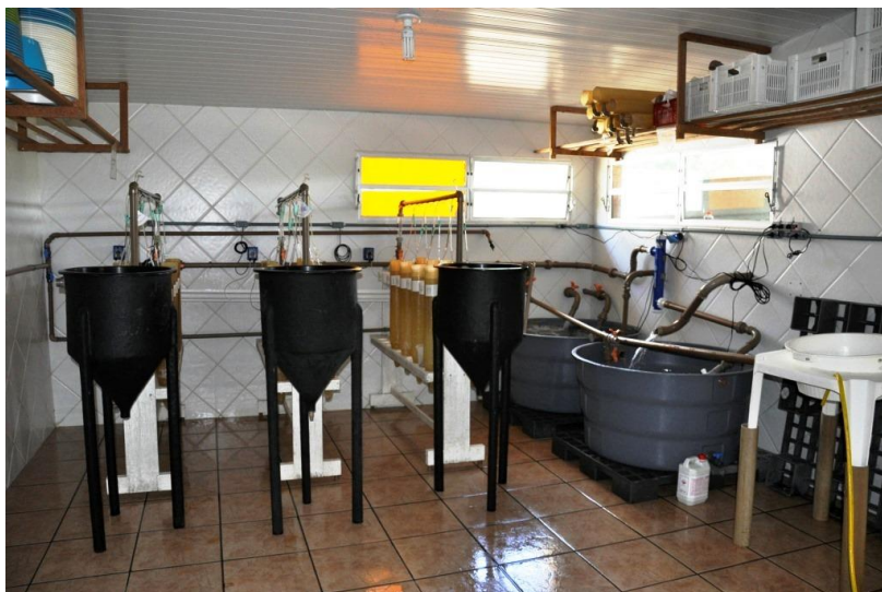
ANEXO A – Foto do sistema de recirculação de água utilizado no experimento. (Fonte: LMM).
