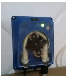
ANEXO D – Bomba peristáltica (SEKO®) que compõe o sistema. (Fonte: LMM).
