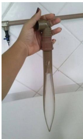
ANEXO F – Filtro utilizado em cada tanque de larvicultura para evitar fuga das larvas. (Fonte: LMM).
