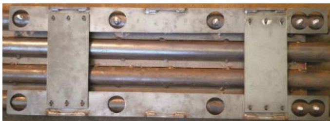
Figura 5.32. Gabarito utilizado para soldagem dos pinos
