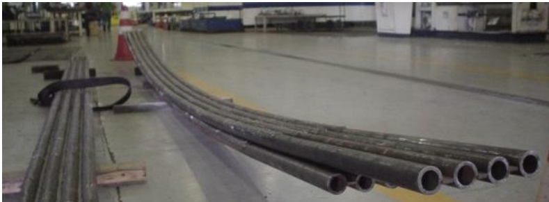
Figura 2.11. Deformação em painel revestido
