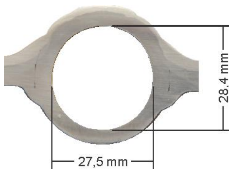
Figura 6.5. Ovalização em tubo novo revestido com o uso do MIG/MAG corrente contínua
