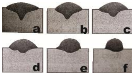
Figura 2.28. Ilustração das alterações das seções transversais no processo MIG CA. Em (a) polaridade inversa, em (b) 10% polaridade direta, em (c) 30% polaridade direta, em (d) 50% polaridade direta, em (e) 70% polaridade direta e em (f) 90% polaridade direta [55]
