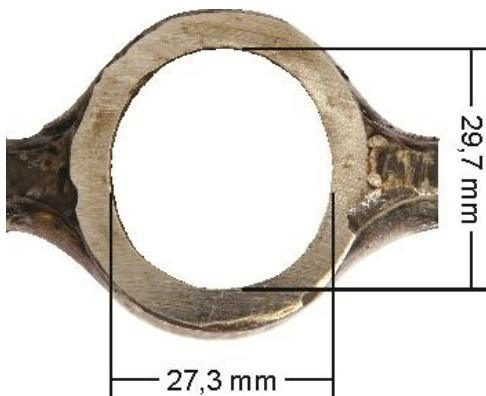
Figura 2.12. Ovalização em tubo novo revestido
