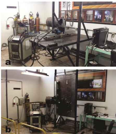
Figura 4.1. Bancada para ensaios comparativos. Em (a) configuração para posição plana e em (b) para posição vertical
