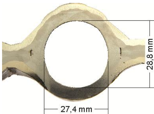
Figura 6.2. Ovalização em tubo novo revestido com o uso do TARTÍLOPE V4
