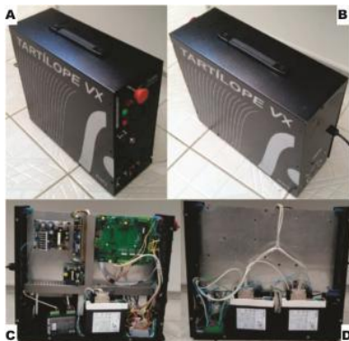
Figura 5.21. Painel eletroeletrônico com tecnologia ARM: (A) vista frontal, (B) vista traseira, (C) vista lateral direita e (D) vista lateral esquerda
