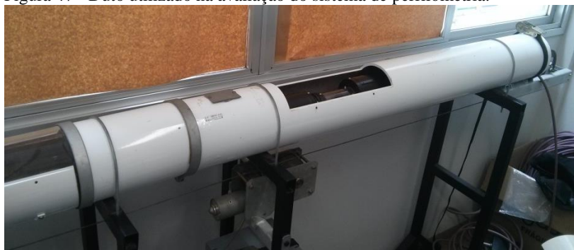
Figura 47 - Duto utilizado na avaliação do sistema de perfilometria.
