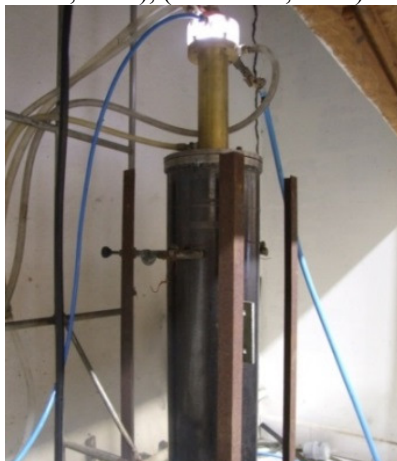
Figura 11. Sistema de plasma acoplado ao reator (BALDISSARELLI, 2012), (PATENTE INPI, 2007), (KHALAF, 2009).
