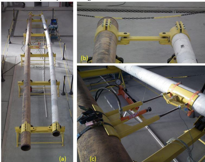
Figura 29 - (a) Padrão de flexão e (b) detalhes do módulo de fixação e (c) módulo de aplicação de carga
