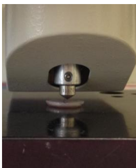
Figura10 - Ponteira Indentadora Vickers no microdurometro.
