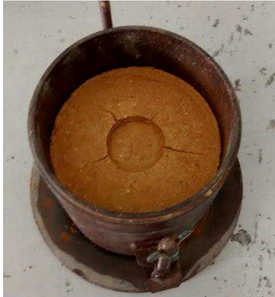
Figura 3.10 – Corpo de prova após penetração do pistão.
