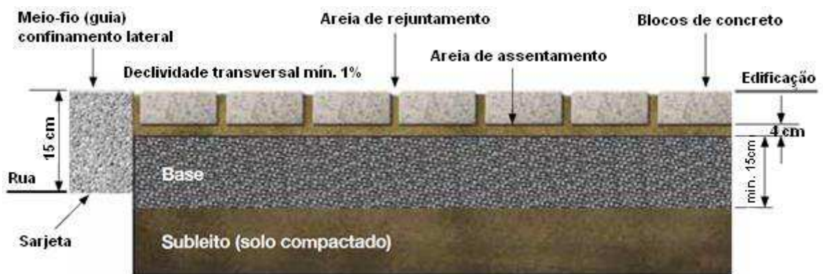
Figura 2.11 - Estrutura de pavimento intertravado tipicamente utilizada para soluções de pavimentação para tráfego muito leve e leve (ABCP, 2010).
