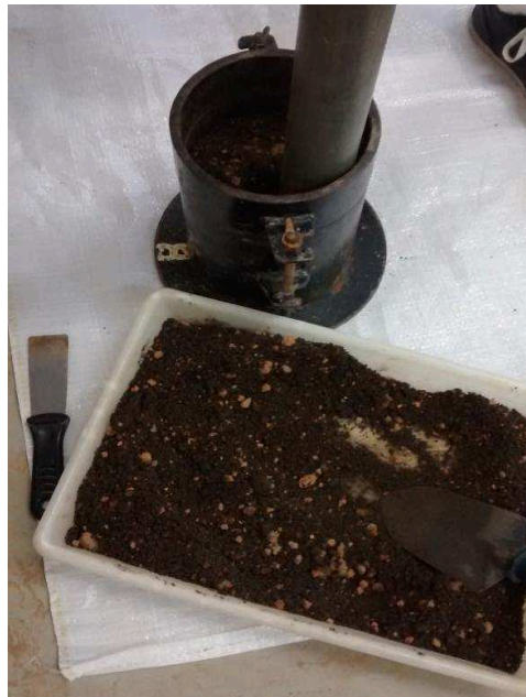
Figura 3.28 – Compactação Proctor com 50% ADF.
