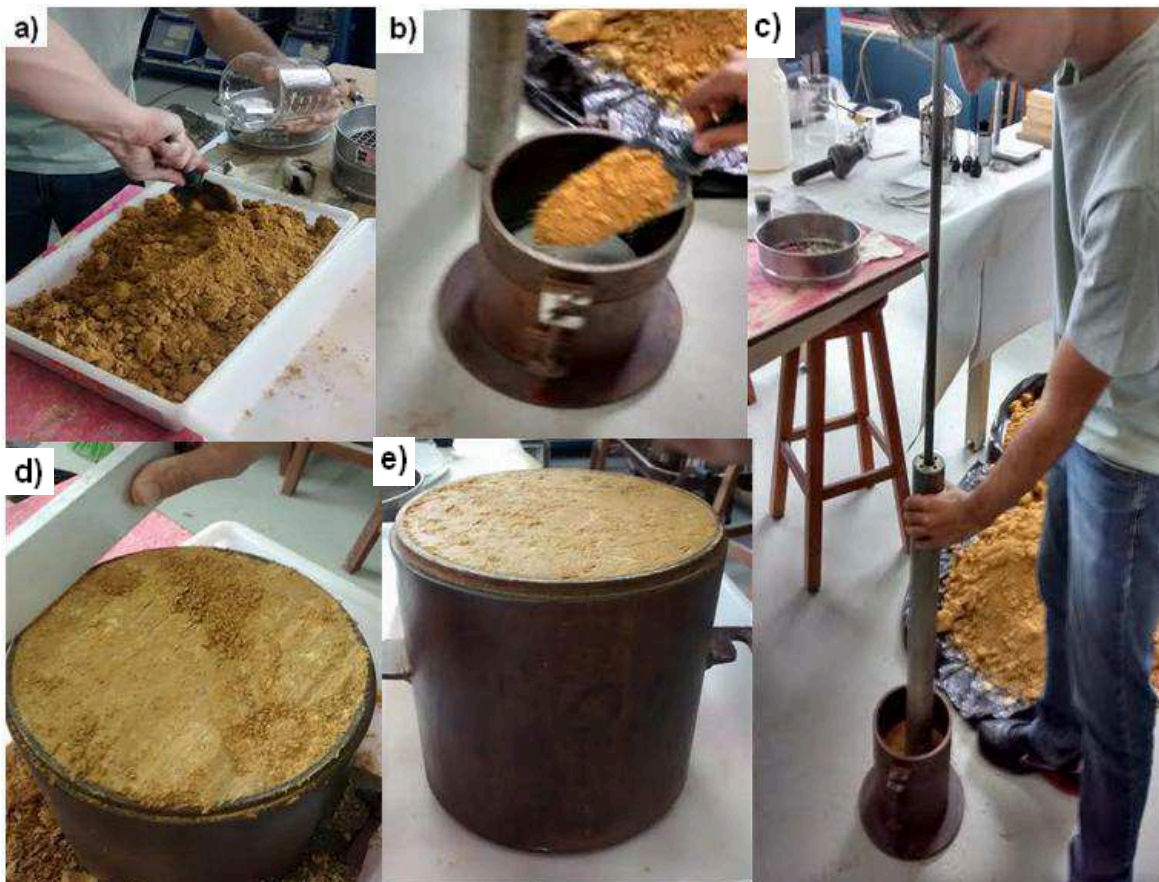
Figura 3.7 - a) acréscimo de água; b) colocação solo no cilindro; c) compactação; d) rasamento; e) cilindro rasado.
