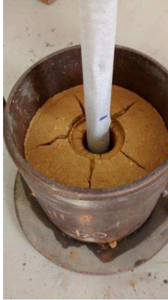
Figura 3.15 – Ensaio DPL em corpo de prova.
