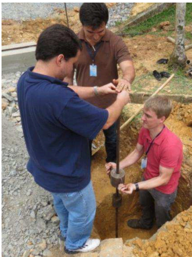
Figura 3.13 – Ensaio DPL realizado no solo 1
