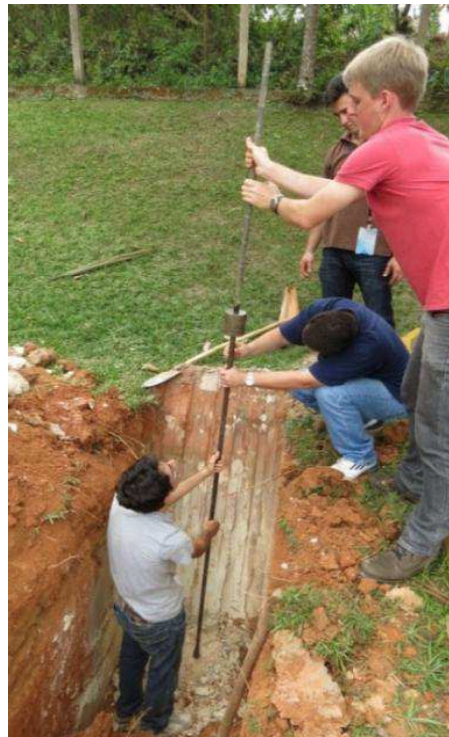
Figura 3.20 – Execução ensaio DPL no pátio 2.
