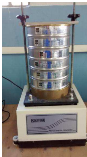
Figura 3.41 – Ensaio de granulometria por peneiramento.
