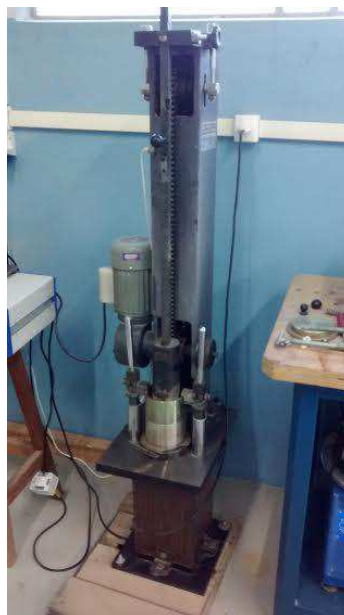
Figura 3.34 – Corpo de prova sendo ensaiado no soquete Marshall.
