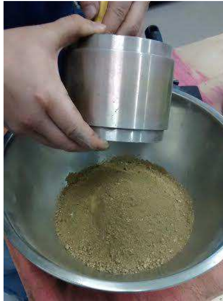
Figura 3.35 – Saibro após compactação Marshall.
