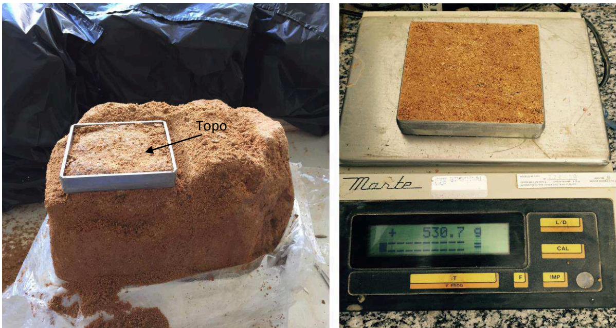
Figura 26 - Preparação e pesagem da amostra para ensaio de cisalhamento direto
