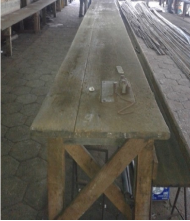
Figura 12 – Dobragem utilizando bancada com pinos
