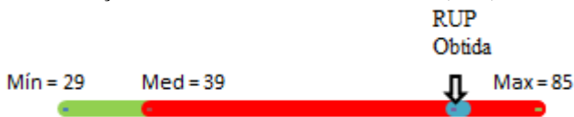
Figura 53 - Armação de estrutura de concreto armado (Hh/t) – MOP geral
