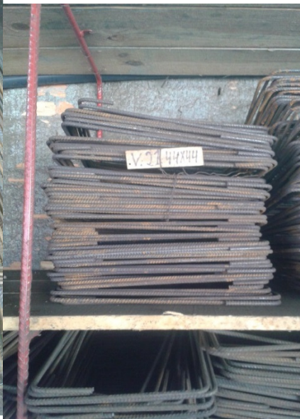
Figura 7 – Estoque de estribos pré-cortados e pré-dobrados
