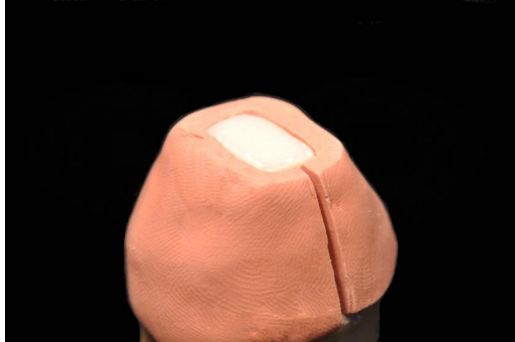
Figura 14 - Barreira de silicone posicionada
