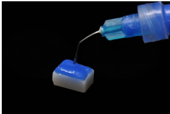
Figura 16 - Aplicação do ácido fosfórico no bloco
