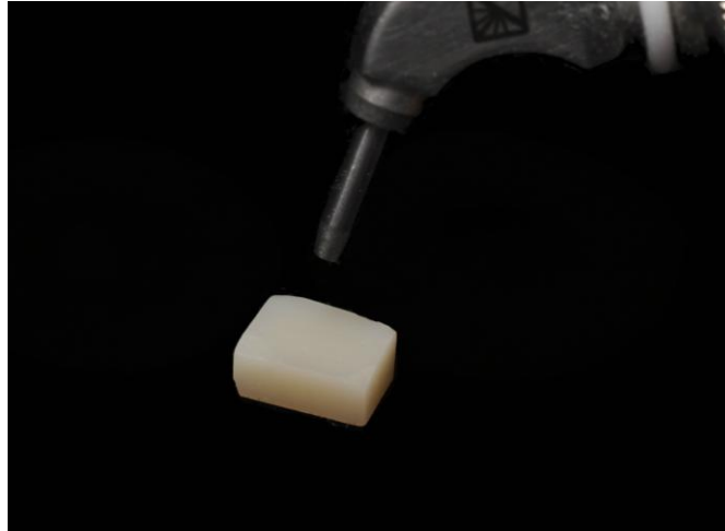
Figura 15 - Jateamento com óxido de alumínio do bloco
