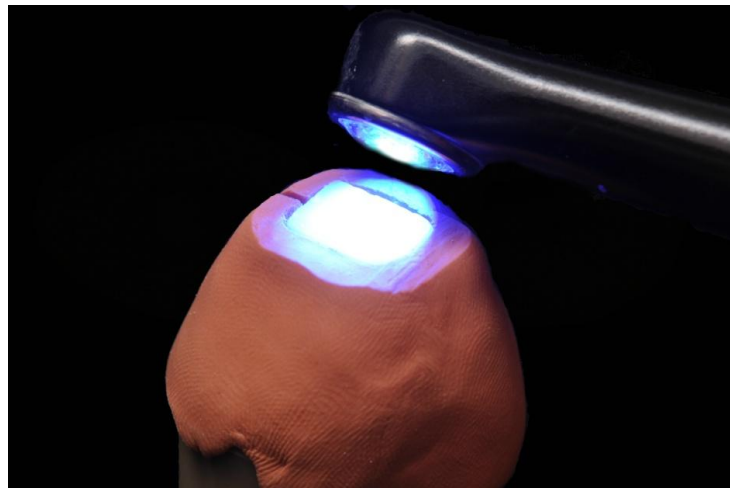
Figura 30 - Fotoativação do conjunto dente/bloco sem a presença do peso
