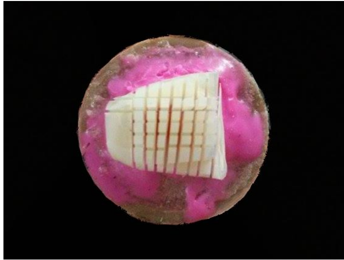
Figura 31 – Conjunto dente/bloco após o início das secções
