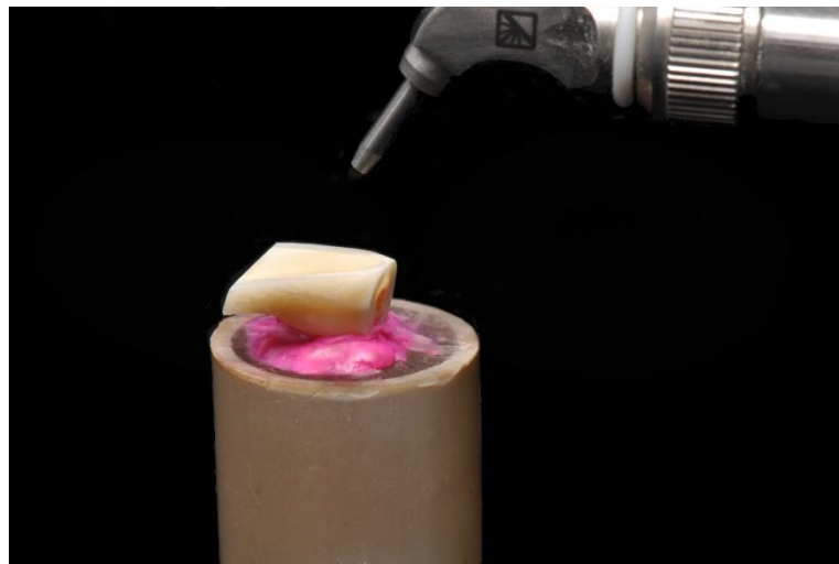
Figura 18 - Jateamento com óxido de alumínio do substrato dentário
