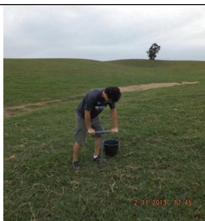
Figura d – Coleta de solo para avaliação de variáveis que posam identificar à vulnerabilidade do solo a contaminação por dejetos suínos.
