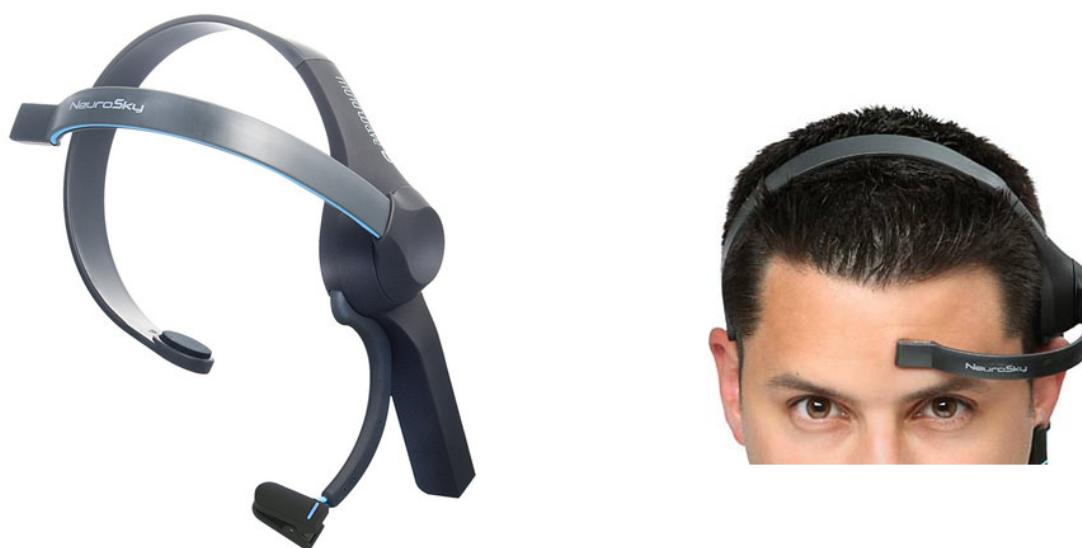
Figura 9 – Equipamento de EEG Neurosky Mindwave Mobile(esquerda) e sua forma de utilização(direita). Fonte: (NEUROSKY, 2014)
