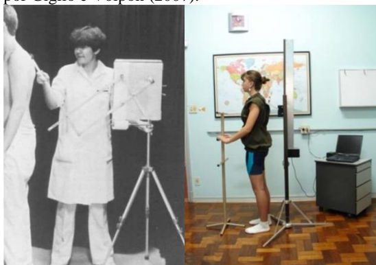
Figura 86 - Pantógrafo adaptado por Wilner (1981) e Pantógrafo digital criado por Giglio e Volpon (2007).
