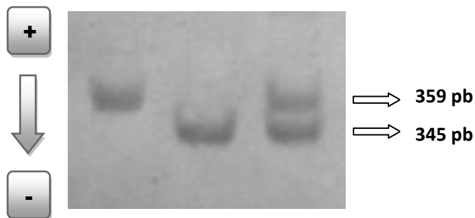
Figura 6 - Gel de poliacrilamida a 7%, corado com nitrato de prata. Fragmentos de DNA de dois diferentes tamanhos, 359pb (Inserção 14pb) e 345pb (deleção 14pb), podem ser observados após corrida eletroforética de 3horas, a 160 V. O gel digitalizado ilustra uma inserção (raia1), uma deleção (raia 2), uma inserção ; deleção (raia 3).
