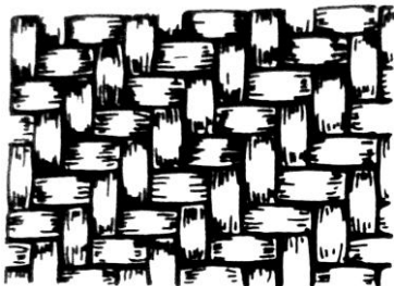
Figura 15 - Trançado cruzado diagonal ou sarjado 44
