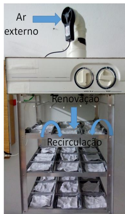
Figura 2: Esquema de renovação de ar, e recirculação de ar.
