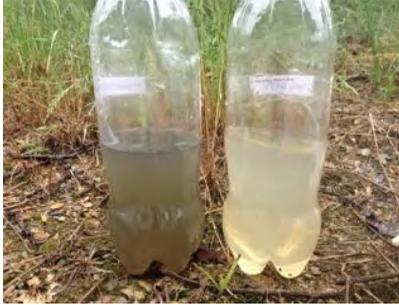
**Figura 11 - Afluente (à esquerda) e efluente (à direita) do WCH de Agronômica.**
