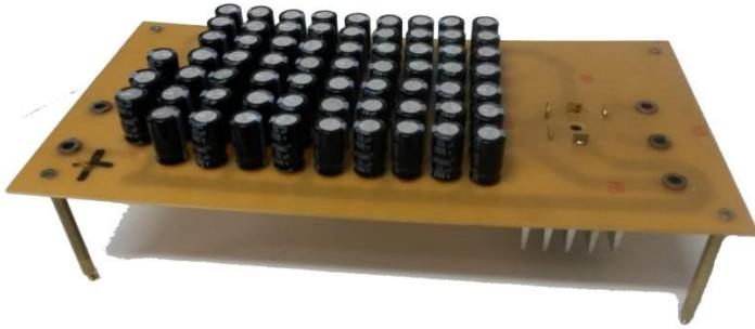
Figura 5.4 – Barramento Capacitivo.
