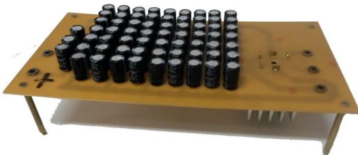
Figura 4.4 – Barramento capacitivo.
