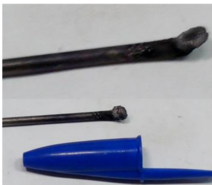
Figura 29 – Imagem mostrando o material de carbono sólido depositado na extremidade do eletrodo EB após cada experimento.
